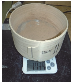
図 10, ふるい 150 目に残った粉の計量結果
