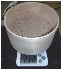
図 8, ふるい 100 目に残った粉の計量結果
