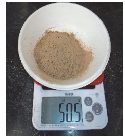
図 11, ふるい 150 目を通過した粉の計量結果
