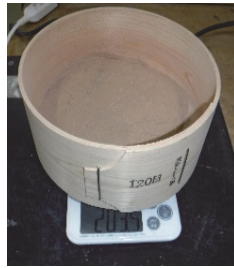
図 9, ふるい 120 目に残った粉の計量結果
