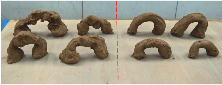
図 26 アーチ状にして粘土から水分を抜く
